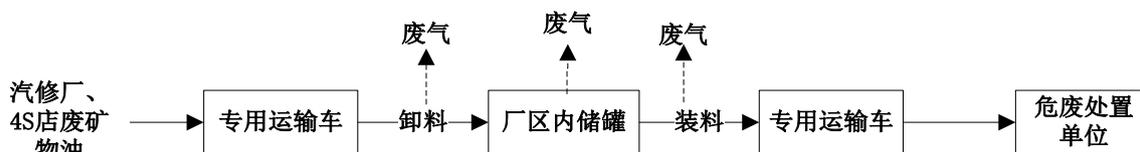
图 2-4 项目工艺流程及产污节点图
